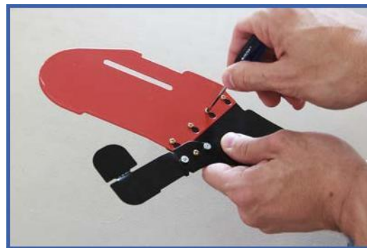
Zdjęcie 19: Używając śrubokrętu wymienić dynamiczny element
