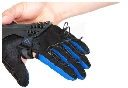
Fig.23 Desanclar los tensores MCP
