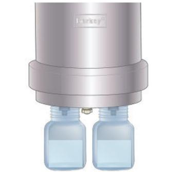
**5** Examinez l'eau dans chaque verre. Si l'eau filtrée a une teinte rose ou rouge, vos éléments ne fonctionnent pas correctement. Assurez-vous que vos éléments sont installés correctement et répétez le test. Si vos éléments continuent à ne pas fonctionner, veuillez nous contacter.
