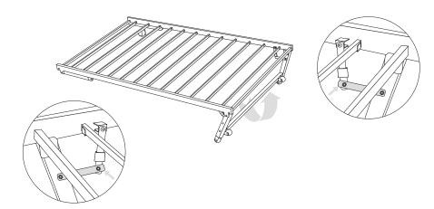
STRAIGHTEN THE HINGE AND SECURE THE LEGS STRUCTURE BY MOVING THE SECURITY CAPS DOWN.
