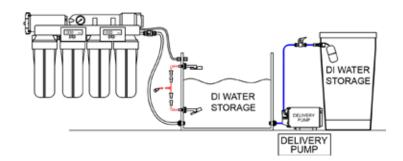
USE DELIVERY PUMP TO DELIVER WATER WHERE NEEDED FOR SALT MIXING OR TO SUMP
