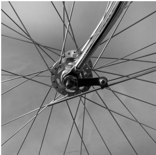
7. Remettez la roue en place sans ses boulons, afin de glisser les pattes de fixation de chaque côté.
