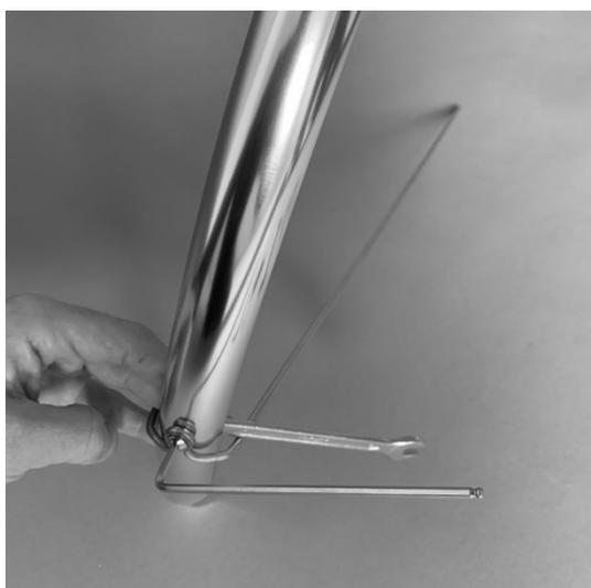
1. Avec la clé alen de 3 et la clé plate de 8, montez la tringle sur le garde-boue.
