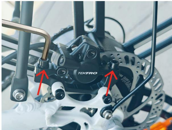
2. Wenn immer noch ein leichtes Reibungsgeräusch zu hören ist, kann es durch Einstellen des Scheibenbremsrotors feinabgestimmt werden, damit die Bremsen optimal funktionieren.
