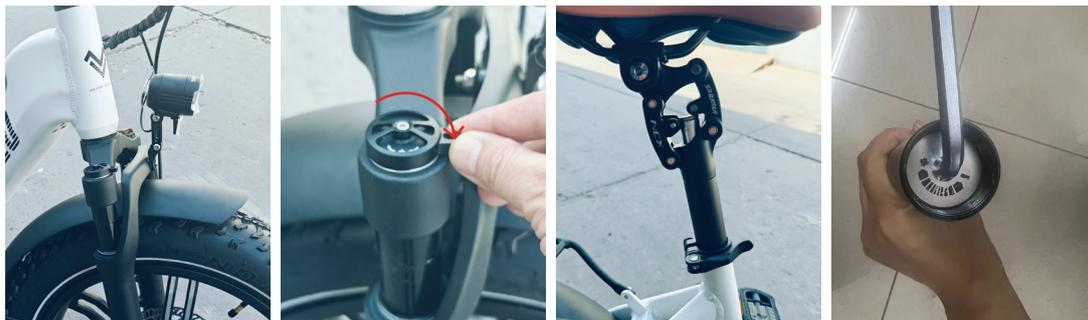
Die Stoßdämpfungsfunktion der Vorderradgabel kann durch Drehen des Schalters gesperrt oder entsperrt werden
