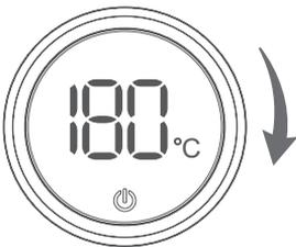
1. Drehen Sie das Wählrad eine halbe Umdrehung nach rechts.
