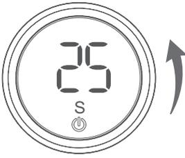
1. Drehen Sie das Wählrad eine halbe Umdrehung nach links.
