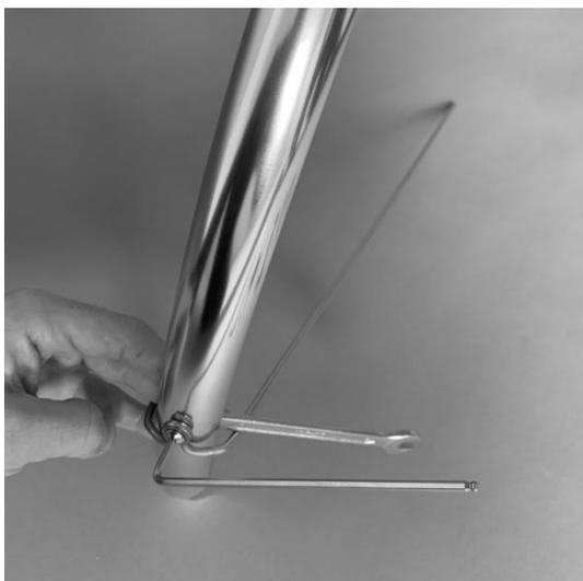
2. Avec la clé allen de 3 et la clé plate de 8, montez la tringle sur le garde-boue.
