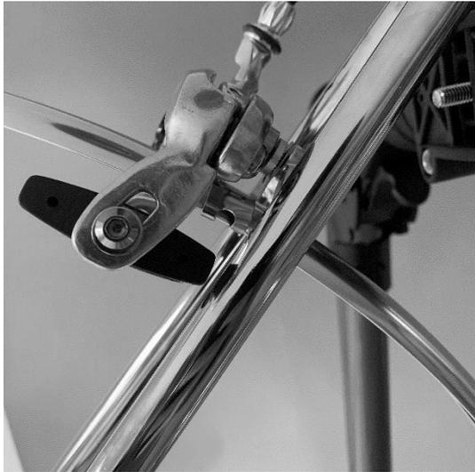
**6. Avant de resserrer le tout avec la vis cheminée, avec la pince plate, resserrez bien la patte sur le garde-boue.**
