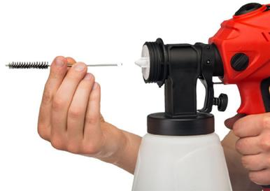
**2.** Entnehmen Sie die bereits eingesetzte Sprühdüse mit einem spitzen Gegenstand (beispielsweise mit der Rückseite der mitgelieferten Reinigungsbürste).
