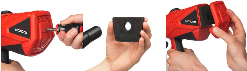
**1.** Ziehen Sie zuerst den Netzstecker aus der Steckdose. Lösen Sie dann die Schraube, um die Luftfilterabdeckung zu entfernen.
