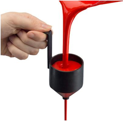
Füllen Sie den mitgelieferten Fließbecher bis zum Rand mit dem von Ihnen gewählten Material. Messen Sie mit Hilfe einer Stoppuhr, wie lange es dauert, bis sich der Fließbecher vollständig entleert.
