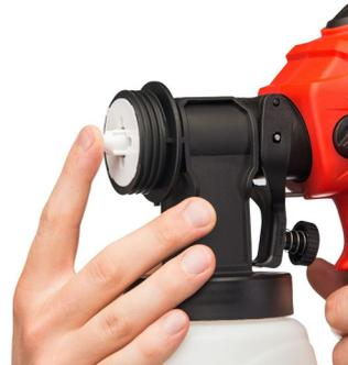
**4.** Legen Sie die neue Sprühdüse ein und vergewissern Sie sich, dass die Spitze gut fest sitzt. Setzen Sie die Düsenkappe auf und schrauben Sie sie fest.
