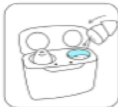
Baje el dispositivo en el estuche de carga con el cable de extracción deslizándose en la sección hueca.
