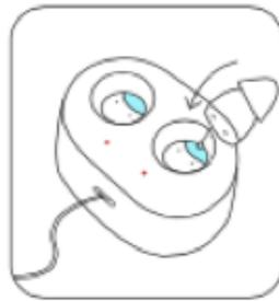
Baje el dispositivo en la base de carga con el cable de extracción deslizándose en la sección hueca.
